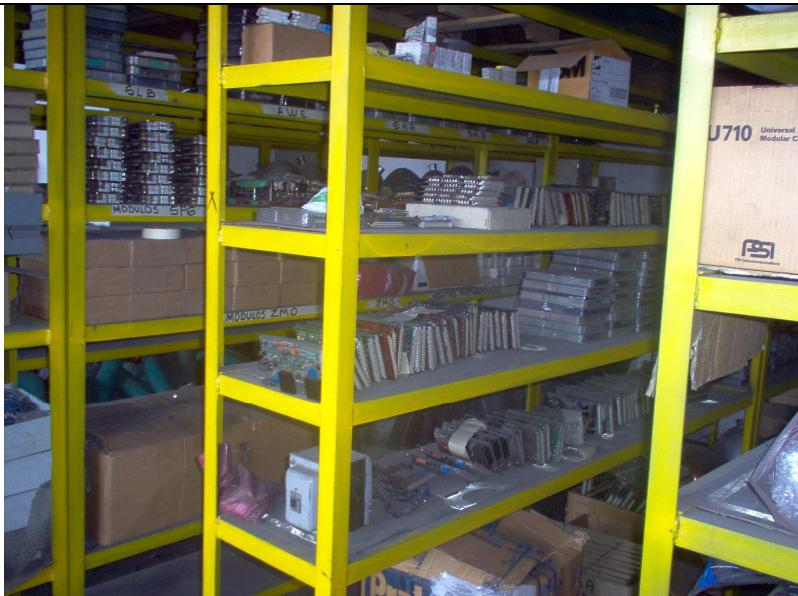
Se evidencia la exposición de factores externos como humedad, polvo, tierra etc, al cual se encuentran expuestos los módulos para equipos de control.
