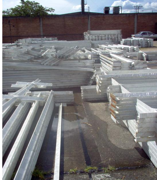
Se evidencian pedestales nuevos sobre pozos de agua, acelerando los procesos de deterioro y oxidación de los mismos.
