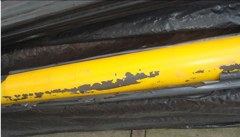
Postes nuevos de semaforización almacenados y recubiertos con poliuretano que al momento de retirarlo arrastra la pintura que los protege.
