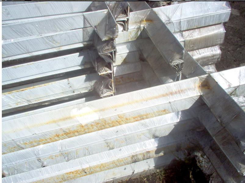
Estado de oxidación de los pedestales nuevos recubiertos con una clase de poliuretano y una vez ingresa agua, al interior del recubrimiento, esta se encapsula y agiliza el proceso de oxidación, de estos.
