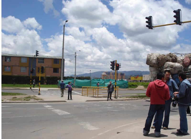
Se observa el estado de la intersección, en donde la demarcación realizada ha comenzado a deteriorarse, en solo 11 meses de funcionamiento
